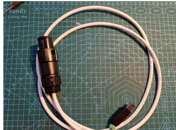
Фиг. 4. Готов вид на комуникационния кабел за пренос на данни от инвертора
